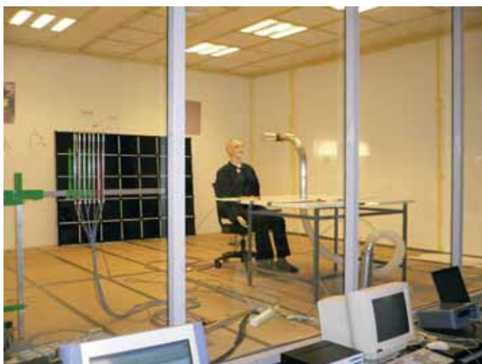
EXHAUSTOs PV-armatur er blevet testet i klimakamre hos ICIEE/DTU.
